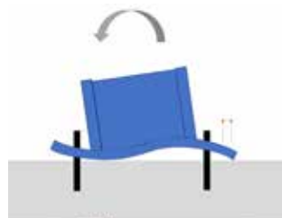
Abb. 6: Verkleinerung des inneren Hebelarms
