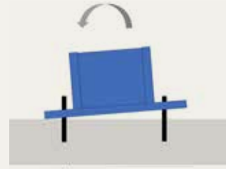
Abb. 3: Das Biegemoment erzeugt Spannung in dem/den Anker(n).
